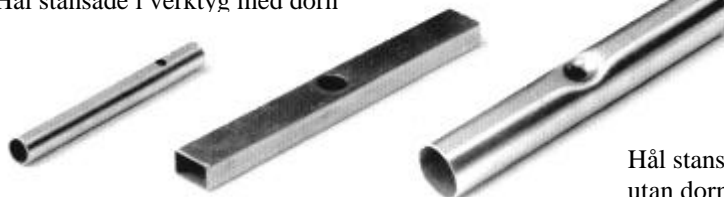
Hål stansade i verktyg med dorn
